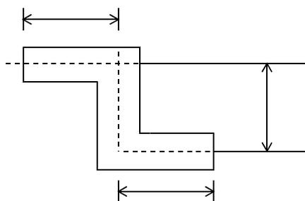
カ 配管配線は原則として図面上の平面部分と立上り、引下げ部分とに区分する。
