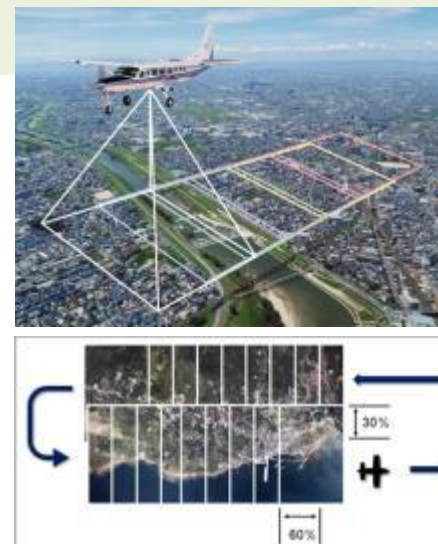
航空機による空中写真測量 ( http://www.gsi.go.jp/MAPSAKUSEI/25000SAKUSEI/satsuei-satsuei.html )
