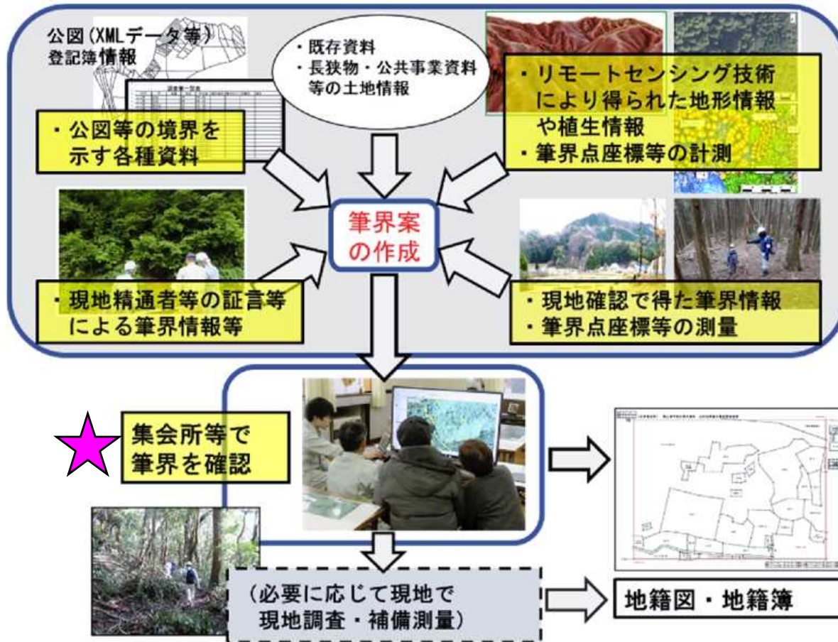
図1 航測法を用いた地籍調査の考え方
