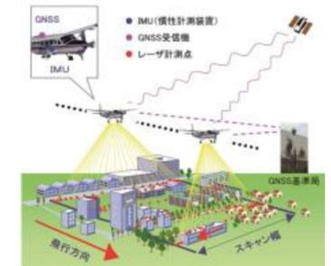
航空機による航空レーザー測量
