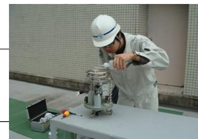
雨量計の点検
