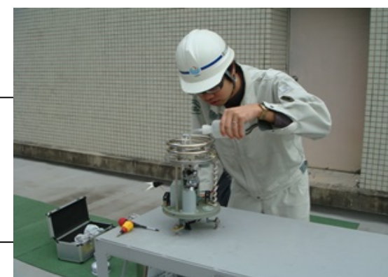
雨量計の点検
