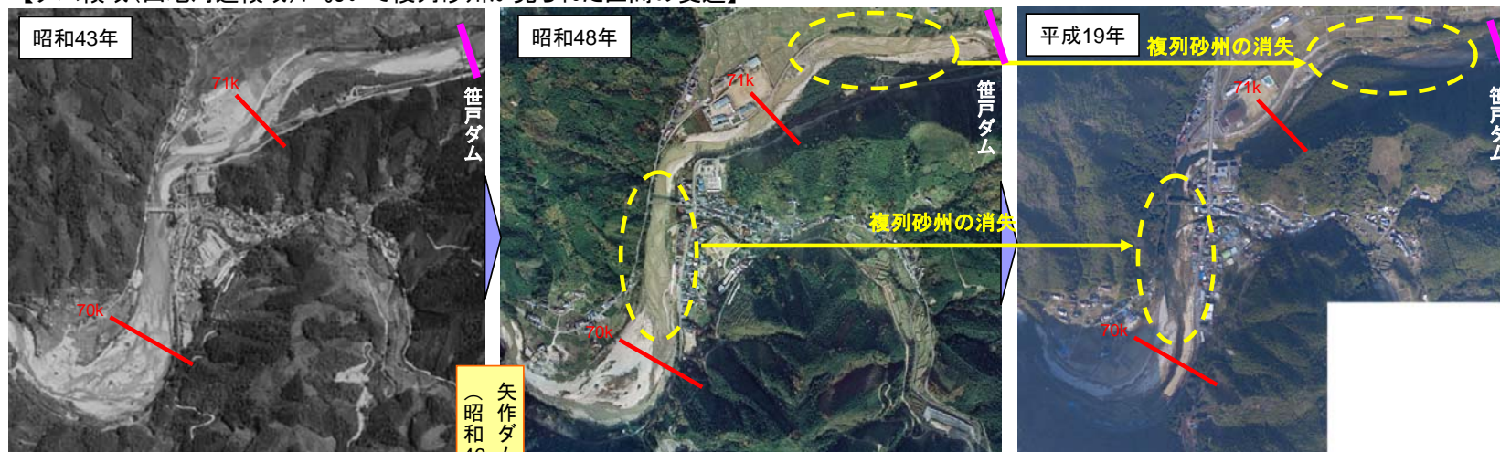
【ダム領域(山地河道領域)において複列砂州が見られた区間の変遷】
