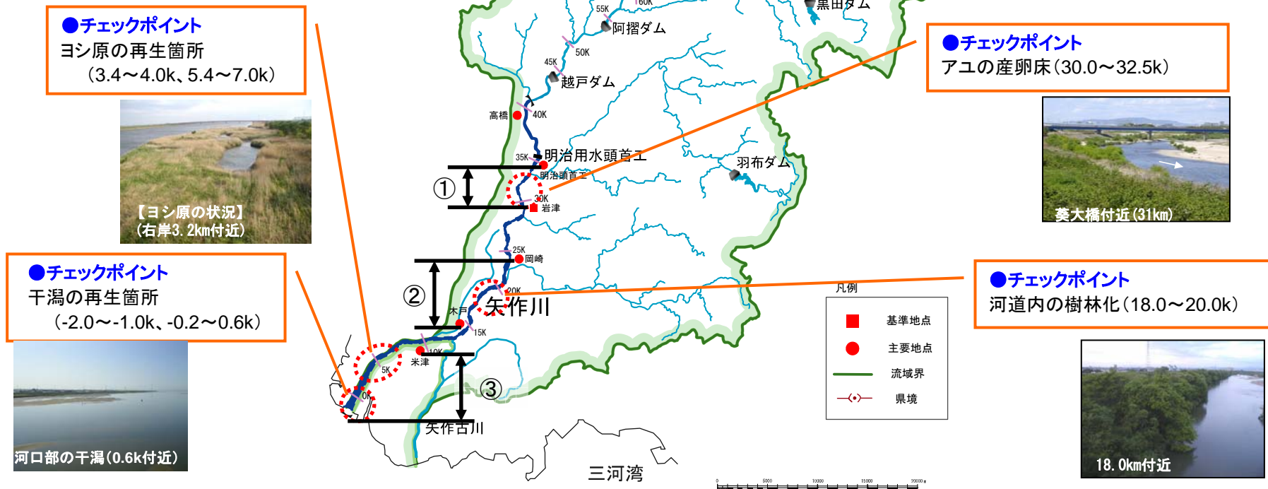
図 平面二次元河床変動計算による検討必要区間(案)
