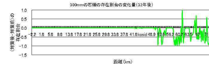
図 3.12 排砂による各河床材料の占める割合の変化
