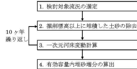
図 1-3 緊急対策における掘削可能標高設定フロー
