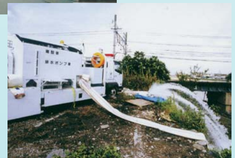
平成12年9月の東海豪雨 時に活躍する排水ポンプ車 (庄内川水系新川)
