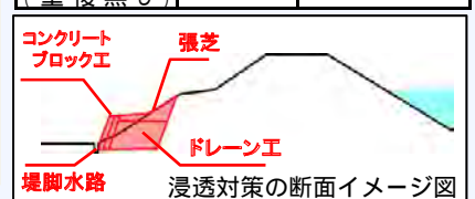
浸透対策の実施例(牛川地区)
