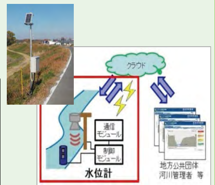
危機管理型水位計の設置
