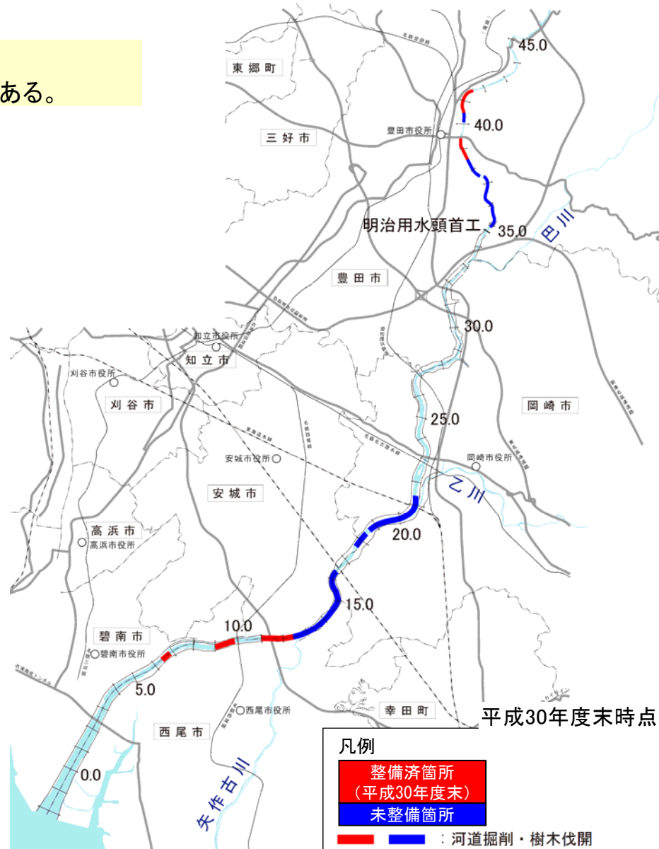
河川整備計画策定以降の水位低下対策箇所
