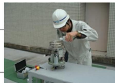
雨量計の点検
