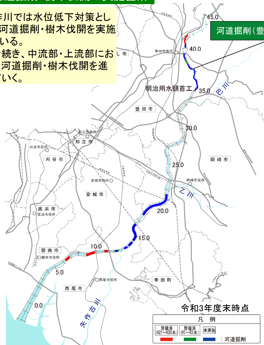
河川整備計画策定以降の河道掘削箇所
