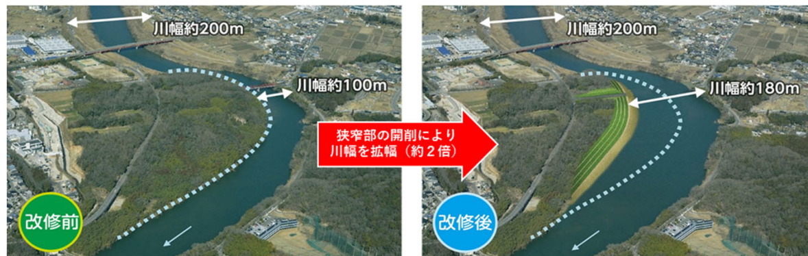
●鵜の首地区水位低下対策事業における整備箇所・整備イメージ
