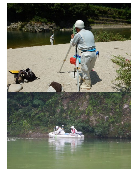
定期縦横断測量
