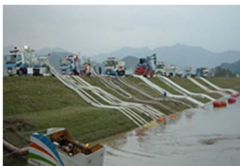
排水ポンプ車による緊急排水
