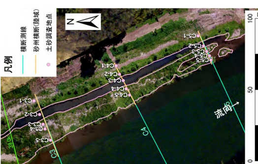
図-1 横断測線と土砂調査地点
