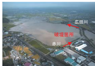
広田川流域の浸水状況(H20.8.29) (破堤箇所 赤川合流点 10k900 付近)
