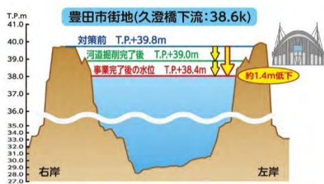
…… 対策による水位低下効果(横断面) ……
