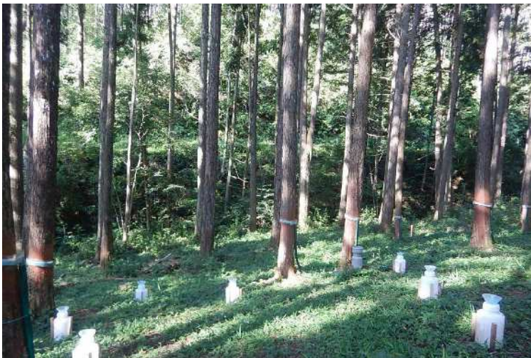
雨水遮断量のうち葉、枝、樹皮の遮断量（樹冠遮断量）を観測している様子 熊本県立南陵高校小馬床演習林にて、2023年7月29日（筆者撮影）
