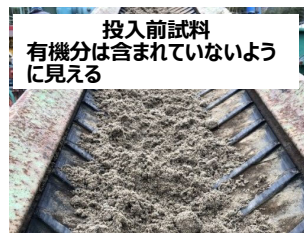
R4年度実験での矢作ダム堆砂(左)と 分級過程で抽出された有機分(右)
