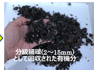
R4年度実験での矢作ダム堆砂(左)と 分級過程で抽出された有機分(右)
