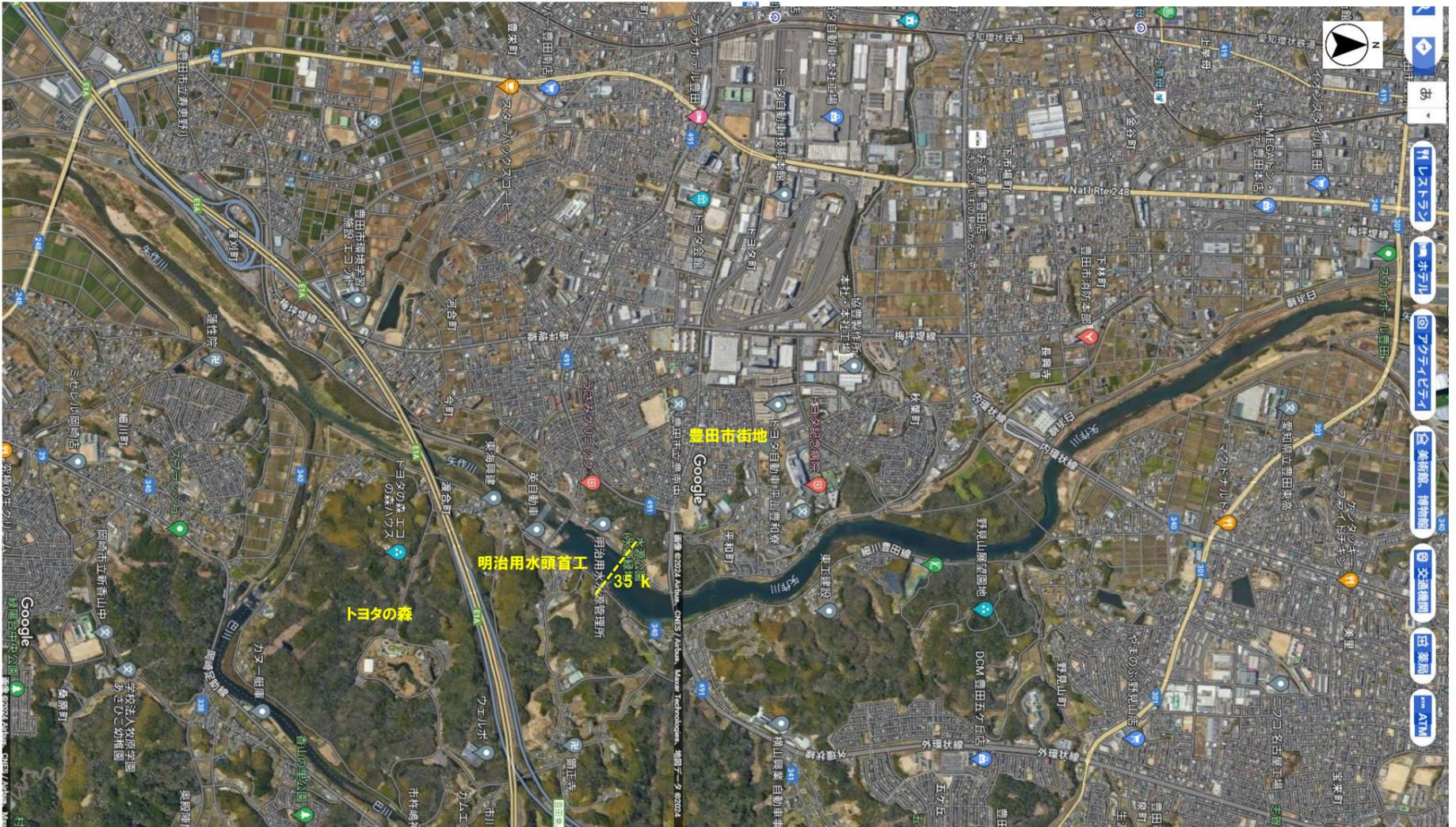
矢作川：明治用水頭首工により矢作川の流況、河川環境が大きく変化しているのがわかる。明治用水頭首工の上下で河川環境のストーリーが大きく異なる。堰より上流には複列砂州はなくなり、下流に比べ河道が細くなり、流路が固定化している。提内地側は豊田市街地が分布しているが、河川沿いは農地が分布し、左岸側はトヨタの森の樹林地が分布している。
