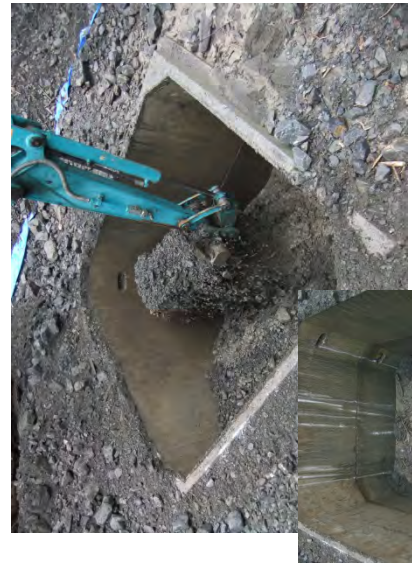
採砂ピットによる 掃流砂の調査観測
