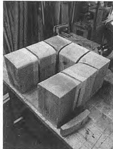
●工房で撮影した原寸模型 削っては座りの繰り返し。座り心地を検討したモデル。
