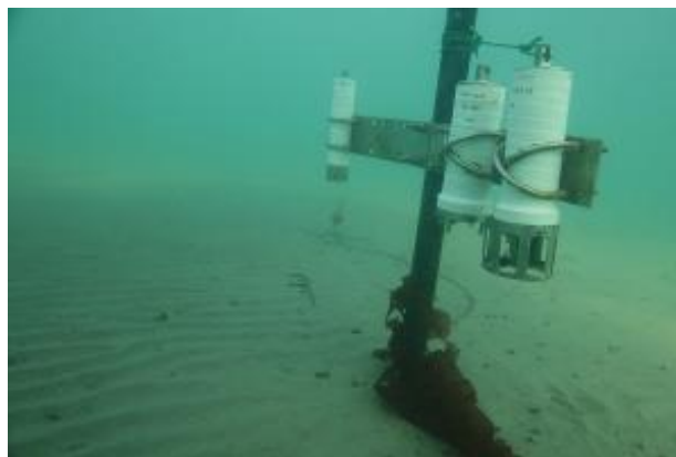
秋のアサリ調査用観測器の設置（三河湾衣崎沖、透明度が高く餌が少ない） * 愛知県水産試験場HPより
