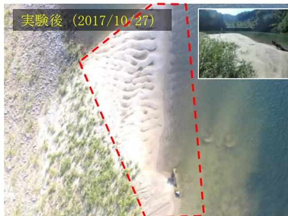
資料：給砂実験後の土砂の堆積状況
