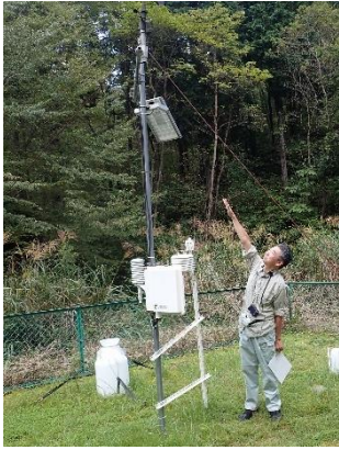
気象観測施設。雨量・気温・湿度・風速・降雨水質等を測定している。
