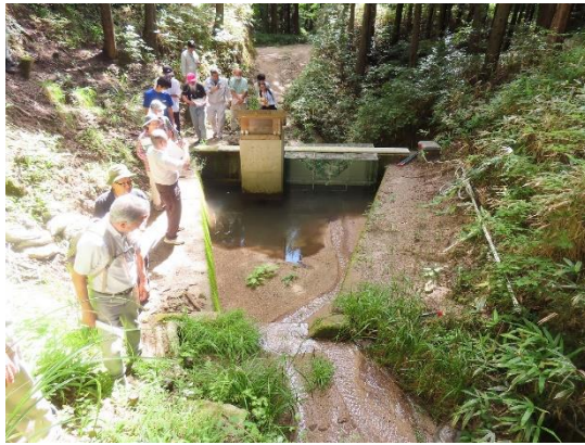
流域の最下流に設置された堰。水位が5分間隔で計測されており、時々刻々の流量データが取得されている。
