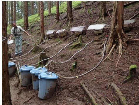
斜面からの土砂流出量の観測。土砂が箱に入り、水はホースを伝って容器に入る。
