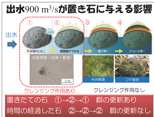
図40 付着藻類の変化からみた出水(900 m 3 /s)と礫の安定との関係。
