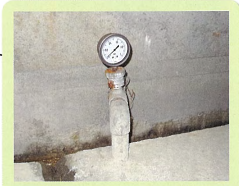
地面がダムを持ち上げる力を測っています。
