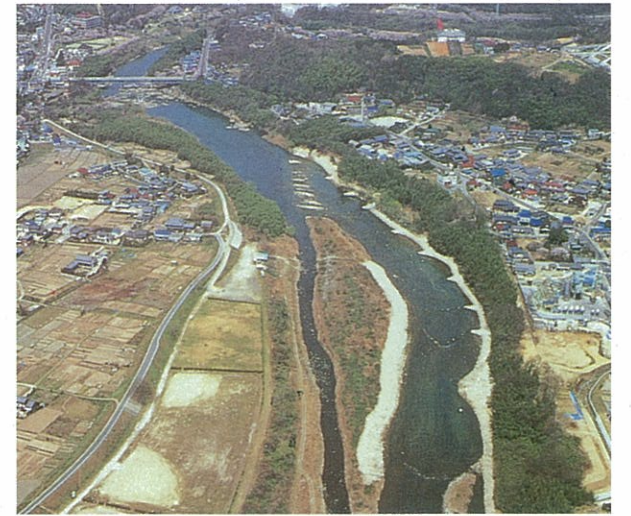
矢作川平戸橋下流(豊田市扶桑町) この地点での計画流量Q=5,300m 3 /s(1/150年確率) 流速V=3.7m/s 河床勾配1/750
