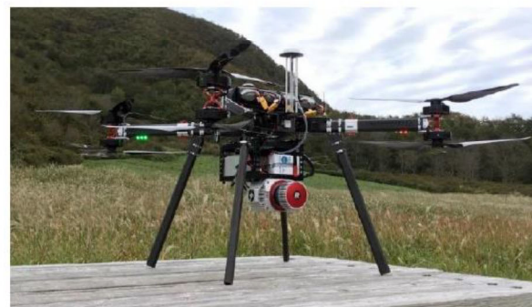
レーザースキャナを搭載したUAV(ドローン)
