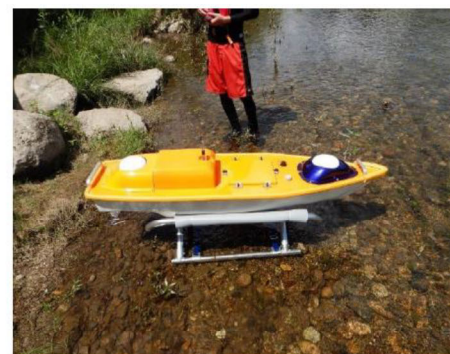
音響探査機を搭載したラジコンボート
