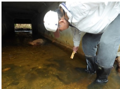
水深や河床材料の計測
