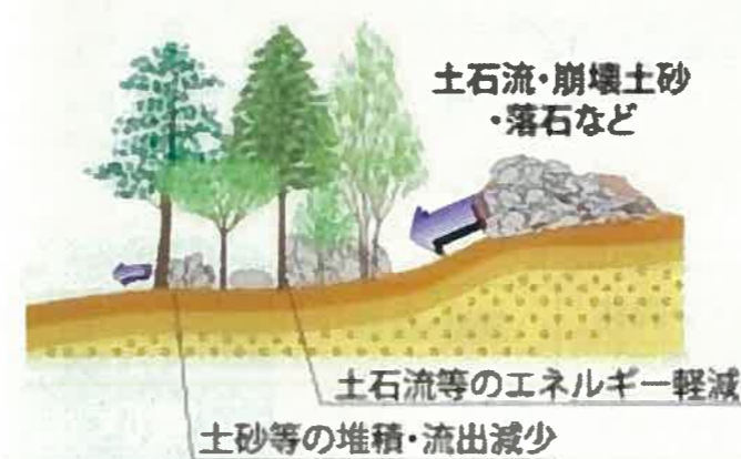
【森林の災害緩衝機能の模式図】 立木の幹が太く、根系による樹幹支持力が発達しているほど、土石流や崩壊土砂等の勢いを軽減することができます
