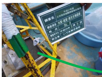
採泥器を用いて底質を採取
