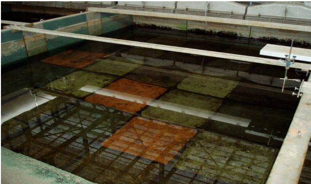
区画内を1m×1mに仕切り、各種の造成材を敷設
