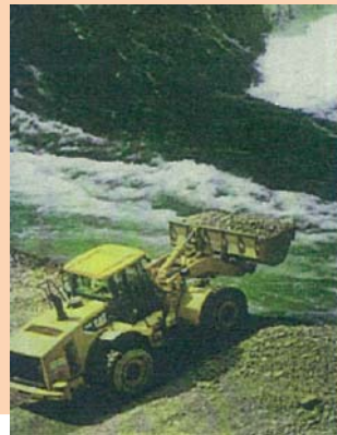
ホイールローダーによる直接投入 (Trinity R.)
