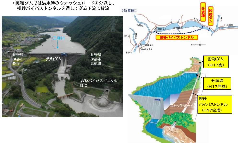
図 4-5 対策工法のイメージ：土砂バイパストンネルのイメージ（美和ダム）
