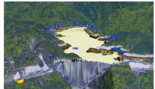
ナローマルチによる堆砂状況調査
