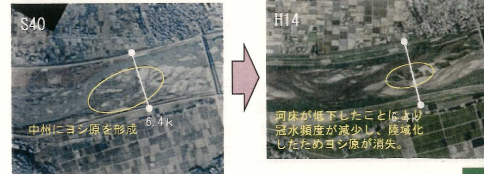
砂利採取等により河床低下が進行し、中州の冠水頻度が減少し、陸域化したことによりヨシ原が消失。
