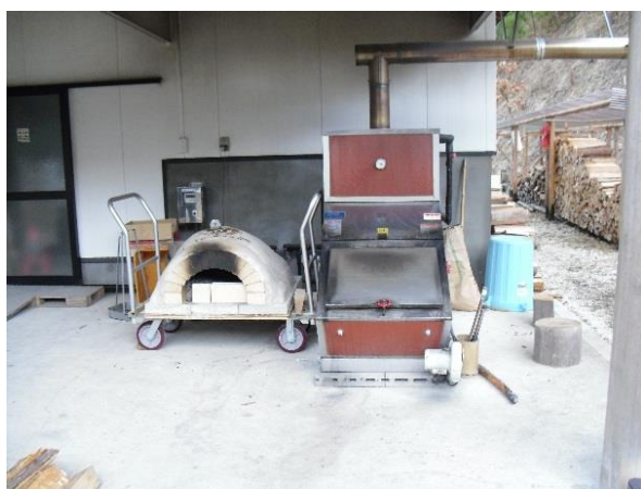
移動式の石窯と薪ボイラー
