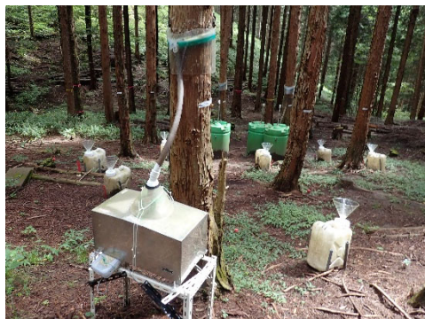
樹木に樹幹流採取器、林内に林内雨採取器を設置し、樹冠遮断量を観測している。
