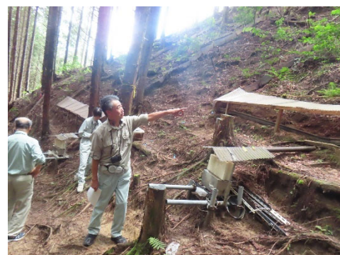
斜面からの流量の観測。雨どいを設置し、表面を流れた水が雨どいに入る。
