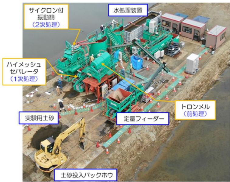
図-1 ダム堆砂分級工法のシステム一例 (R1年度 高滝ダム実)
