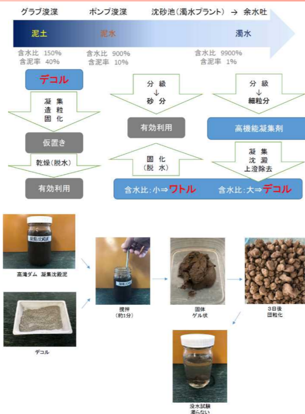
図-12 細粒分改質材(フトル・デコル)の適用状況
