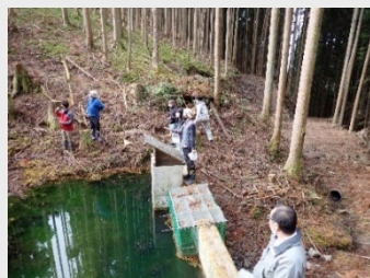
流下する水などを計測するダム
