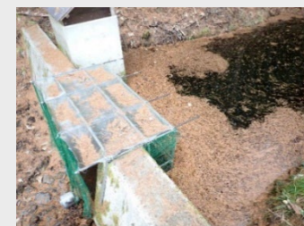
流下する水などを計測するダム
