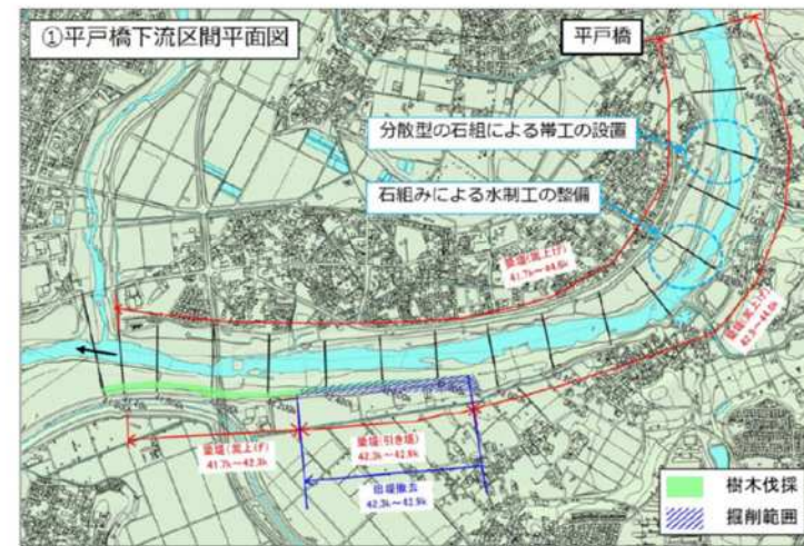
図-3.1.4 河川工事・環境対策の施工箇所と内容・整備イメージ(矢作川〔籠川合流点～平戸橋〕)
