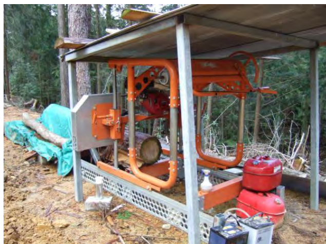
現場にある移動式製材機(40cmまで製材可能)
