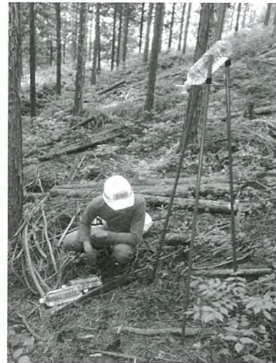
写真1: 現場で組み立てた状態の人工降雨装置
