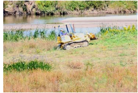
再繁茂抑制のため、ブルドーザーによる踏み倒しを実施（令和2年11月）
