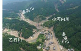
④赤谷川における 土砂・洪水氾濫及び流木による被害 (福岡県朝倉市)
